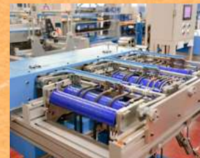
ケーブル寿命試験機（久留米）
