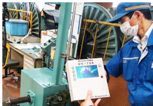
設備のエア漏れ検知状況
